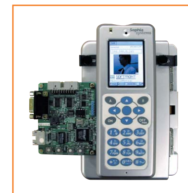
インテル PXA270アプリケーションプロセッサ対応 SIP-IPモバイル電話開発キット
